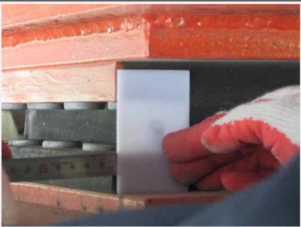
P1 교량반침 이동량 측정(영천)
